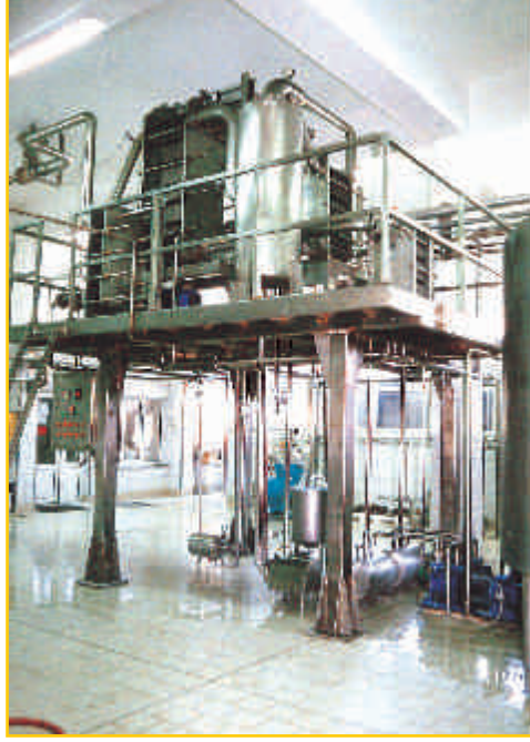
YOĞURT VAKUM EVAPARATÖRÜ Yoghurt Vacuum Evaporator
