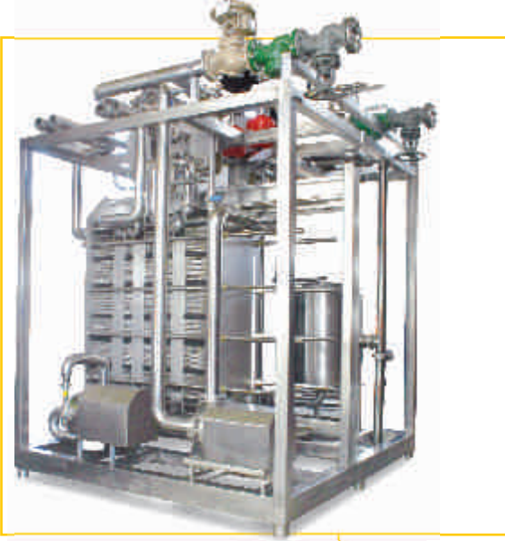
SALAMURA PASTÖRİZATÖRÜ Brine Pasteurizer
